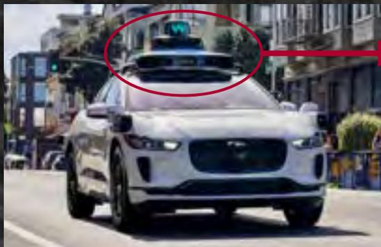
LiDARを取り付けたWaymoの自動運転タクシー
