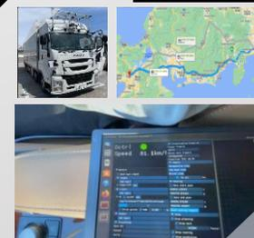
レベル4自動運転トラックの技術開発を実施、並行して幹線輸送サービスの事業性検証を実施。自動運転トラック開発、安全走行体制検討、運送会社との協力体制構築等を経て、2022年8月に事業会社「T2」設立。同11月より公道実験を開始。
