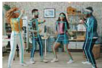
骨格検知 単眼カメラ画像に写る人物ごとに骨格を高速に検出します。
