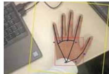
手指の関節点検出 手の領域を検出し、21点のキーポイントを推測するモデルです。
