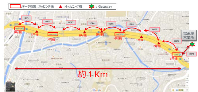
< 図 3: ホッピングによるビーコン伝送実験の中継器配置 >
