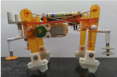
図 3.2 本研究に用いた歩行機械(足パーツを装着したもの)
