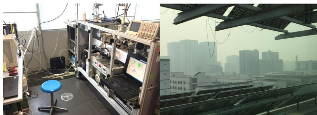
図 4 清華大学 (北京市) での単一微粒子質量分析計 (ATOFMS) による大気観測 (左)。実験室からの眺め (右)。
