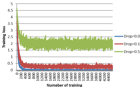
図 4 Dropout の確率による訓練データの学習損失
