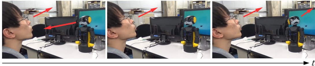
図 3: 人間の視線変化を検出し素早く眼球のみで視線追従を行いサッカード眼球運動を表現, 同時に眼球運動に伴うまばたきが発生, 眼球運動を追うように頭も伴って視線追跡を行う様子
