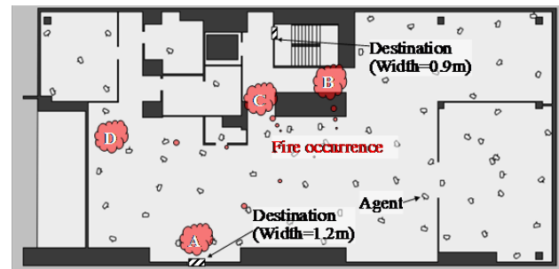
図 3 解析モデル (SimTread)
