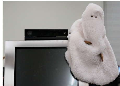
図 4: センサとロボットを取り付けたサイネージの例。黒い箱がセンサである Kinect。
