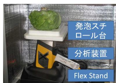
図2 蛍光 X 線計測のためのレタス計測スタンド
