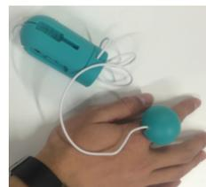
図1 振動式スピーカー(iChargeSound)を用いた触覚提示デバイス
