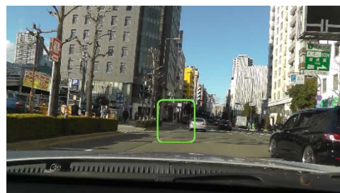
図 4 AR を用いて曲がるべき交差点をフロントガラスへ図示している例
