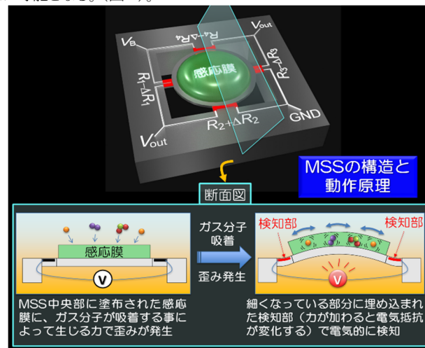
図 1: MSS の構造と動作原理の模式図。
