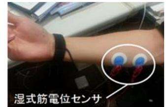
図 6：筋電位センサの設置位置
