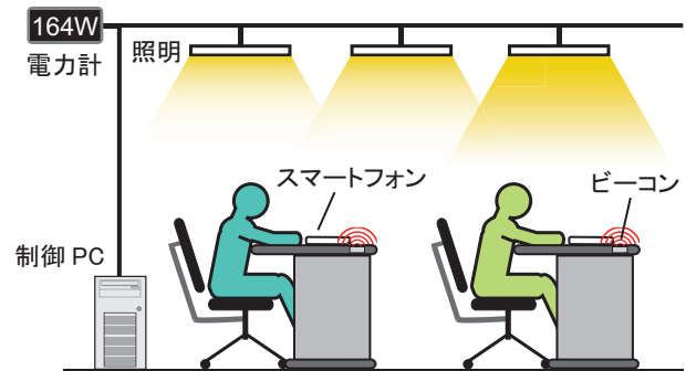
図 2: ビーコン型知的照明システムのイメージ図
