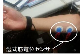
図 5：筋電位センサの設置位置
