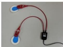
図 3：2 極式筋電位センサ
