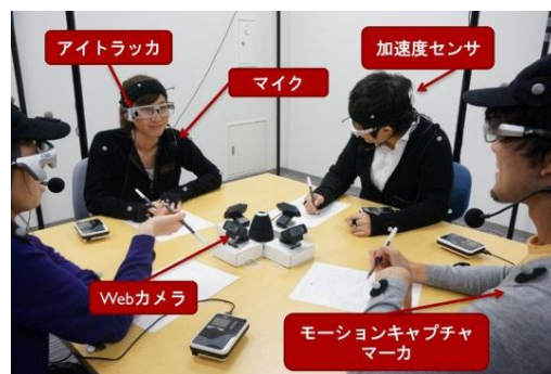
図 3 各センサ装着の様子
