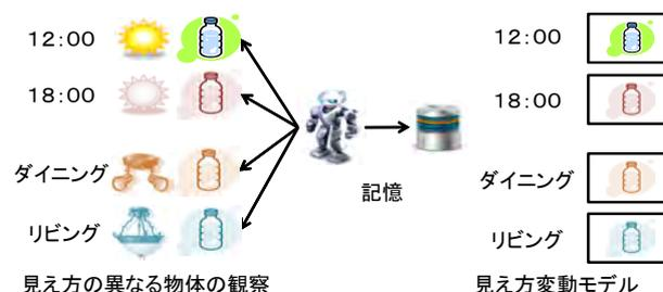
図 1: 既知物体の見え方変動モデルの獲得
