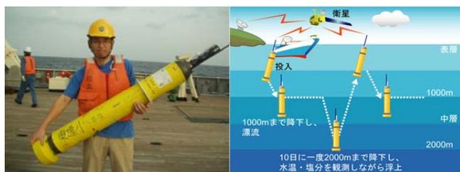
図 2 (左)アルゴフロート(米国 Webb research 社製). 全長約 2m, 重量 30 kg. (右)アルゴフロートの観測サイクル図. 船から投入された後, 1000m 漂流, 2000m から海面までの水温・塩分測定, データ送信という一連のサイクルを約 4 年間持続する性能を持つ.
