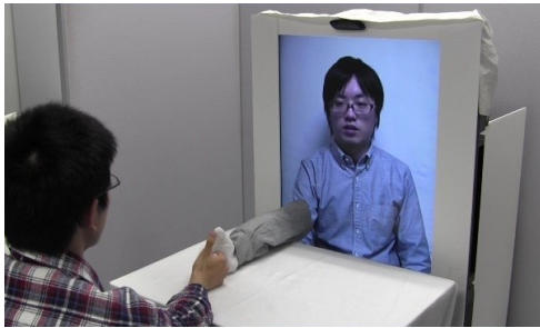
図1 ロボットハンドを実装したビデオ会議システム
