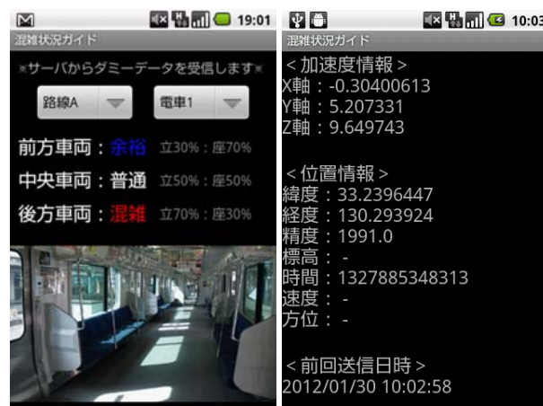
図 3: 判定結果の表示画面(左)と 加速度センサおよび GPS 情報の表示画面(右)
