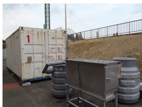
e. コンテナ型多段式 生物処理装置 (帝人株式会社提供)
