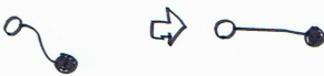
(b) 柔らかい短いひもでつながれた黒いオブジェクトは白いオブジェクトからの距離がひもの長さを超えると追従する
