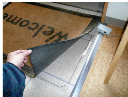
図1 RFIDのアンテナとリーダ装置
