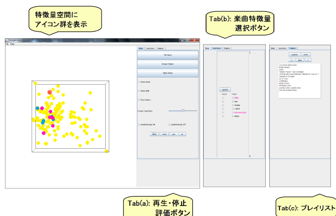
図 1: MusiCube の Window 画面 : Window(左) 各楽曲を立方体領域内 (特徴量空間内) にカラーアイコンで表示する . Window(右) 機能を切り替えるための 3 つのタブがある .
