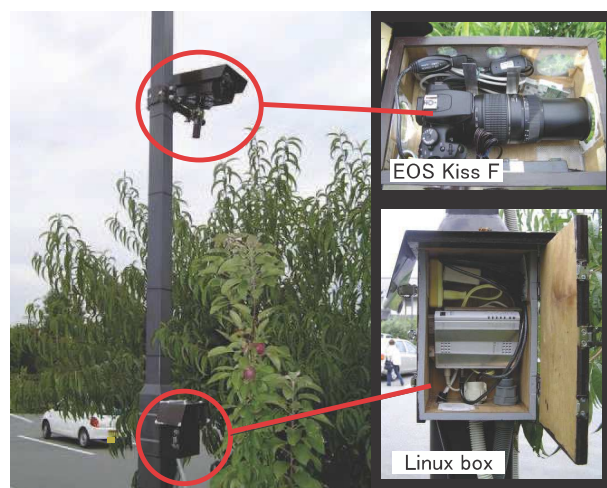
図 1: 一眼レフカメラを用いた高精細モニタリングシステム
