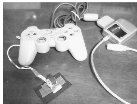
図 4: 入力装置 (プレイステーションコントローラー + USB コンバータ)
