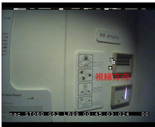
図 2: (左) 視線計測状況: 画角 90 度・絞りは固定・プラス, 四角は左右の視線方向・丸はキャリブレーションしたの視線中心
