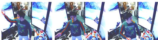
図 4: プロトタイプの動作例．距離情報を用いた動作認識を行っているため，操作者の背後のディスプレイの映像が切り替わっても認識に影響を与えない．右の図のように腕と体に重なりがあるような場合にも，距離情報のクラスタリングを行うことである程度対応ができる．
