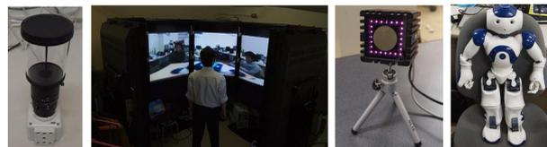
図 3: 本研究で使用する主なデバイス。左から全方位カメラ、円筒形ディスプレイ、レンジセンサ、ロボット NAO
