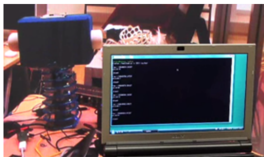
図 2: 日米間 (インターネット) の遅延計測実験の様子。筑波大学の研究室において手前のノート PC から制御コマンドを送信し、UCSD に配置した試作ロボットヘッド (背景左側) を動かす。背景映像は現地 UCSD のカメラから LifeSize Room200 システムを用いてインターネット上を転送された後、筑波大学に配置された大画面モニタ上に映し出されたものである。
