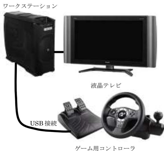
図2 簡易走行装置(簡易装置)
