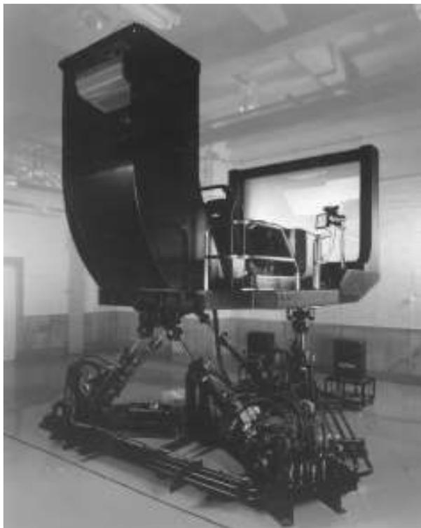
図1 大型ドライブシミュレータ(FS装置)
