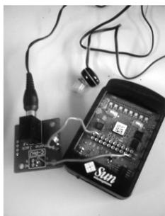
図 1: イヤホンジャックの接続例
