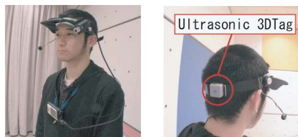
図 3: 装着の様子 (アイカメラ・超音波タグ)
