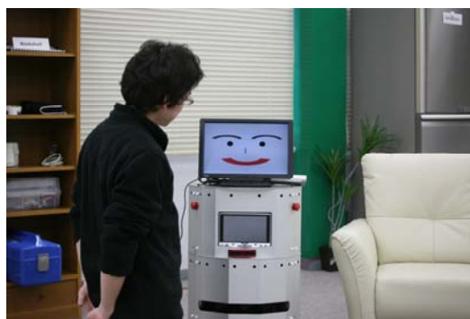
図 4: 表情を制御可能なロボットによる実験
