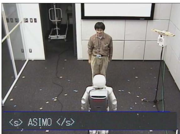
図 3: 音楽雑音下の孤立単語認識: 写真右上のスピーカより音楽が常に流れている。ユーザが 1 名であることを仮定して、ユーザの発話に対して孤立単語認識を行った結果が下部に表示されている。写真はユーザが「ASIMO」と発話し、認識に成功した場合の結果を示している。
