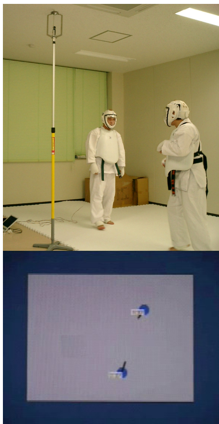
図 3: 自由曲面ミラーカメラによる間合いの抽出
