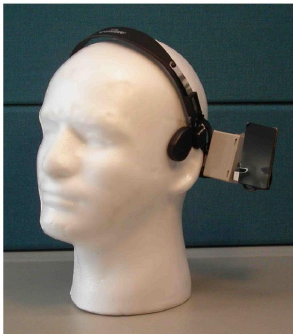
図 5: 無電源小型通信端末 (CoBIT):骨電動ヘッドホンタイプ
