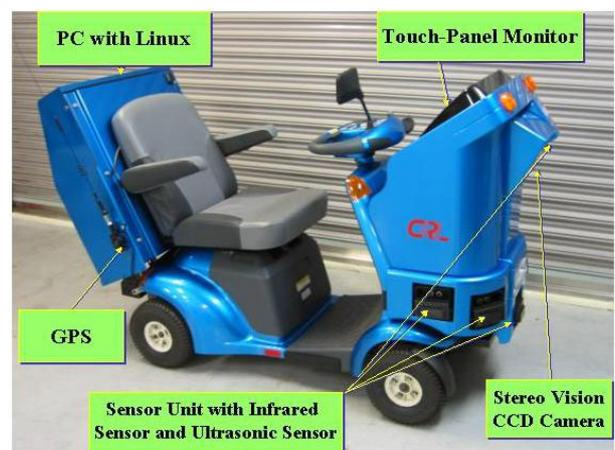
図 3: ユーザ搭乗型移動端末 Intelligent City Walker
