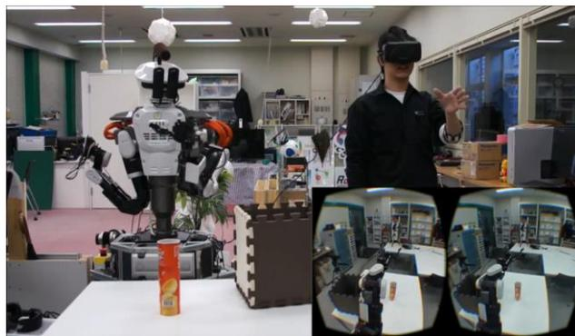
図 1 テレイグジスタンスロボットの操縦の様子
