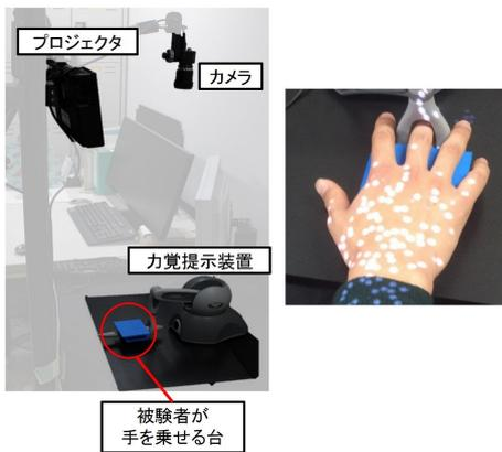
図 2: 実験システムと手にドットパターンを投影した様子
