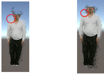
図 2: 点群データのずれ 左側はアラインメント処理前、右側は処理後 赤い丸内のデータの浮き上がりりが修正されているのがわかる
