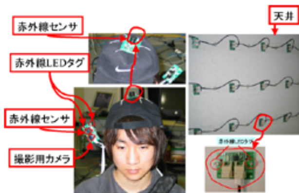
図 4: LPS システム
